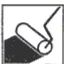
*Pennello e Rullo:* Diluire al 20-25% con acqua sia per la prima che per la seconda mano. Aspettare 5-6 ore tra una applicazione e la successiva.
