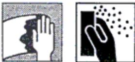
**Per uso esterno:** Applicare una mano di fissativo acrilico FISSACRIL diluito con acqua nel rapporto 1:1 / 1:4. Dopo 4-5 ore dall'applicazione del fissativo applicare per mezzo di un rullo 1 mano di Primer per Marmo Romano per unificare i vari assorbimenti del muro.
